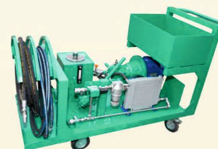
Передвижная гидростанция для испытания гидрооборудования вертолета Ка-32 и Ми-8
