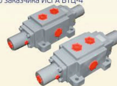
Гидрораспределители Б6234.51 и Б6234.52, изготовленные по образцу, предоставленному заказчиком (разработана конструкторско-технологическая документация, изготовлена оснастка, выполнено литье корпусов и мех. обработка, сборка и стендовые испытания)
