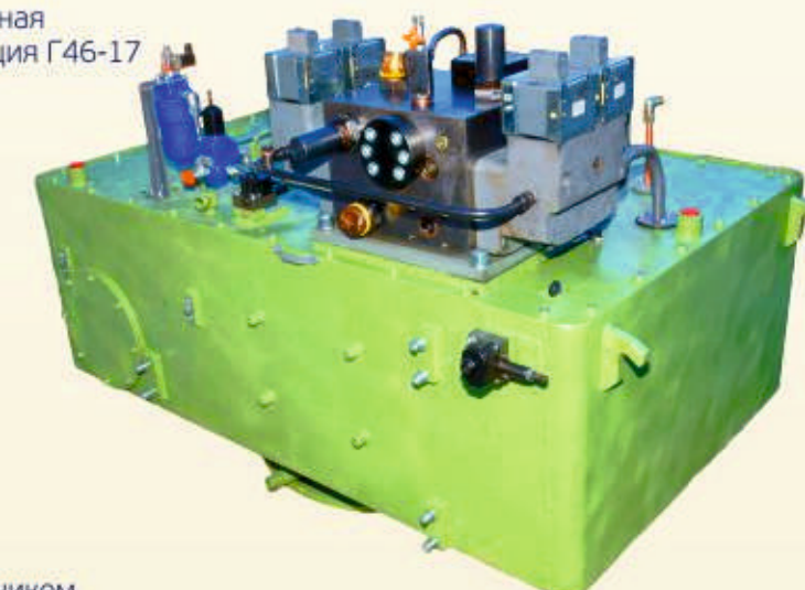
Гидростанция после капитального ремонта с панелью золотникового исполнения, установленной на гидроцилиндре пресса ДА2238
